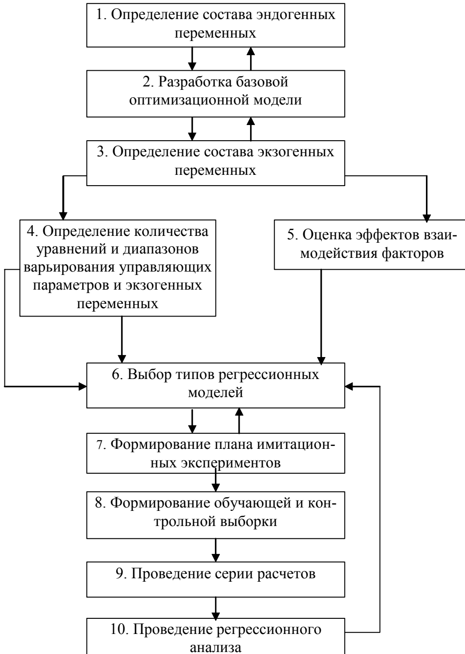
Рис. 3. Структурная схема построения моделей аппроксимации показателей развития электроэнергетики
