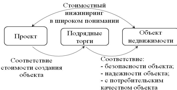
Рис. 2. Стоимостный инжиниринг как процесс моделирования стоимости безопасного объекта недвижимости в соответствии с проектом и с учетом результатов подрядных торгов
